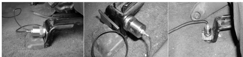
Εικόνα 1 Θέση επιταχυνσιομέτρων (X, Y, Z) κατεύθυνση
